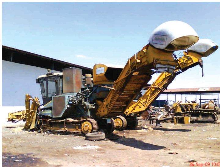
Gambar 2. Mesin tebang tebu ( chopper cane harvester ) di PG Jatitujuh, Majalengka, Jawa Barat (26 September 2009)
