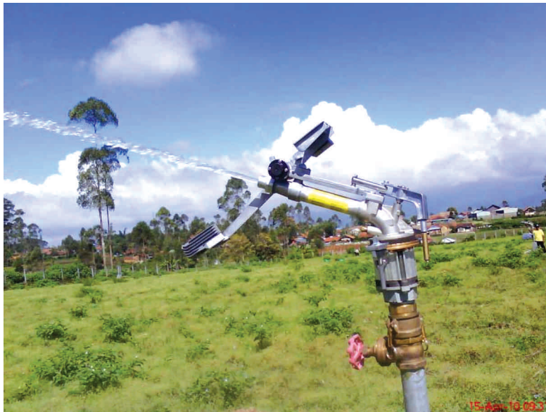
Gambar 5. Contoh big gun sprinkler yang bisa digunakan untuk menyiram tanaman tebu lahan kering (Pengalengan, 15 April 2010)
