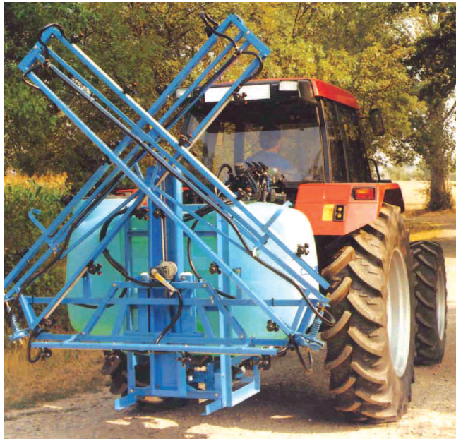
Gambar 6. Contoh boom sprayer yang dapat digunakan untuk mengaplikasikan pupuk cair atau herbisida di areal kebun tebu lahan kering
